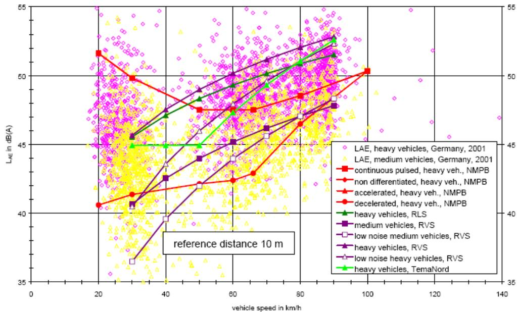
Secondo quanto definito dalla norma XPS 31-133 e a norma delle specifiche della «Guide du Bruit 1980», il livello di potenza sonora  $L_w$  e l'emissione acustica  $E$  sono stati calcolati dal livello di pressione sonora misurata  $L_p$  e dalla velocità del veicolo  $V$  mediante:
